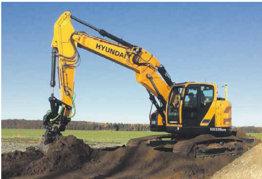
Eine effiziente Kombination: Hyundai Kettenbagger mit MOBA Baggersteuerung. Die Baggersteuerung ist ideal für den Einsatz bei Fundament-, Graben-, oder Böschungsbau, für die Nivellierung oder den Unterwasseraushub.
