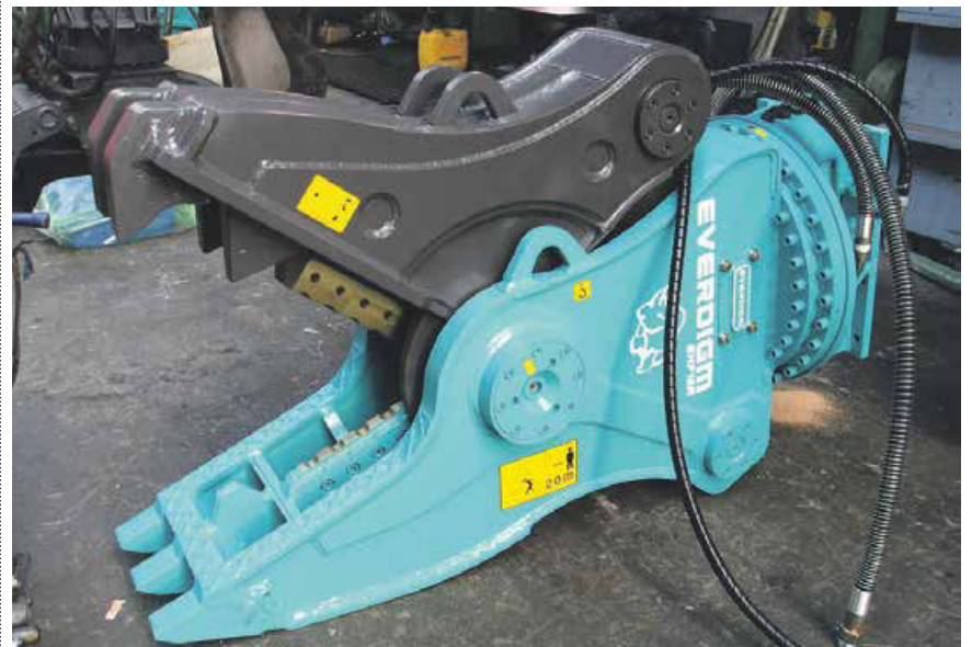
Hydraulischer Betonknacker bietet eine hohe Bruchkraft als auch stabile Bewegung.
